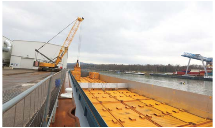
Das Binnenschiff der Klasse V ist rund 110 Meter lang und kann maximal 3.000 Tonnen Nutzlast transportieren; Quelle: Pressefoto Roche.
