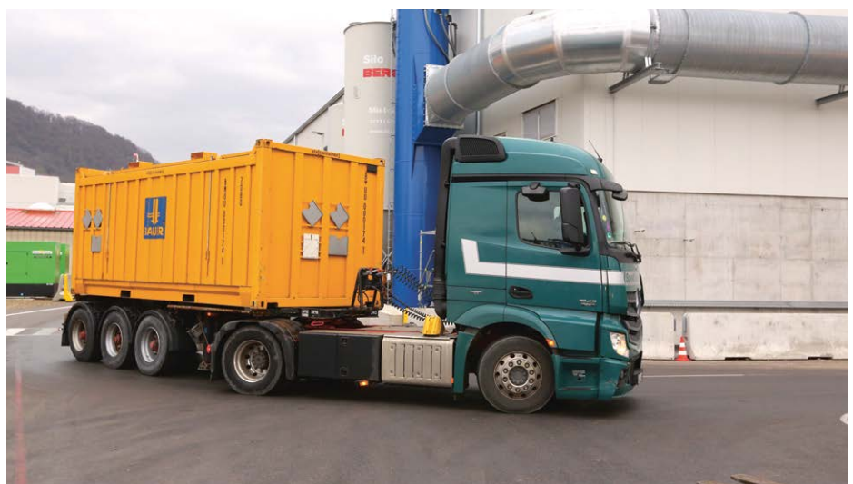
Das Aushubmaterial wird in gasdichte und haveriesichere Spezialcontainer verfüllt, die anschließend mit LKW zum temporären Schiffsanleger transportiert werden; Quelle: Pressefoto Roche.
